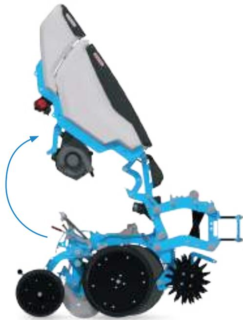
Um die Wartung, Kalibrierung, Einstellung und das Auswechseln von Ersatzteilen zu erleichtern, lassen sich die Behälter und das Sägehäuse des **ValoTerra** Säaggregats in einem Block anheben.
