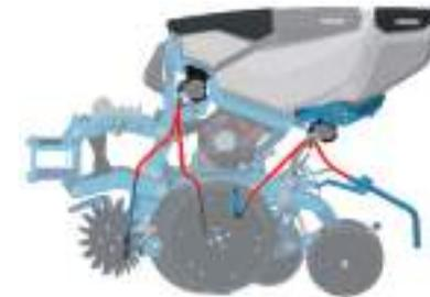
Für die Ausbringung der Mikrogranulate verfügt das System über **4 verschiedene Abgabepunkte**, um eine Ablage der Granulate hinten, vorne, auf die Bodenoberfläche bzw. in die Furche neben dem Saatgut zu ermöglichen. **MicroSmart** gibt den Landwirten die nötige Flexibilität, um die für jedes Mikrogranulat-Produkt bestehenden, besonderen Empfehlungen optimal zu erfüllen.
